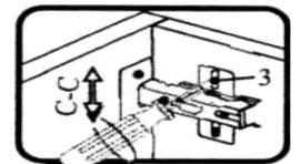
Если необходимо отрегулировать фасад по высоте, нужно ослабить винт 3, отрегулировать фасад в направлении С-С, а затем затянуть винт 3.
