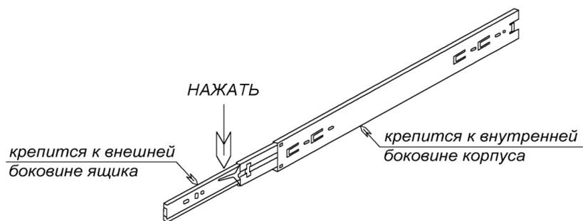
ШАГ 1. Перед началом сборки изделия подготовить направляющие полного выдвижения, разобрав их на две части. Для этого вытянуть внутреннюю планку до предела, нажать на деблокировочный рычаг и снять внутреннюю подвижную планку направляющих. Внешняя неподвижная планка крепится к внутреннему боку корпуса, внутренняя подвижная - к внешнему боку ящика.
