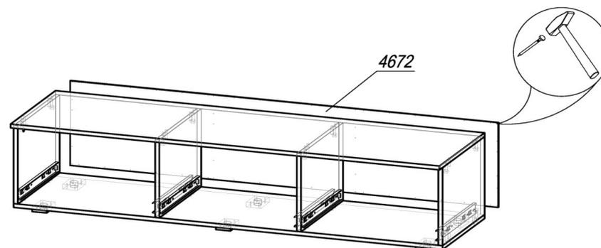
ШАГ 4. Перевернуть изделие лицевой стороной вниз. ЛДВП 4672 прибить гвоздями 2x20 к корпусу, предварительно проверив рулеткой или рейкой равенство диагоналей. Поднять тумбу и установить на место. Вставить собранные ящики в корпус, задвинуть их до фиксации деблокировочным рычагом. При необходимости отрегулировать направляющие. Для снятия ящика нажать на деблокировочные рычаги с двух сторон в противоположном направлении друг от друга.
