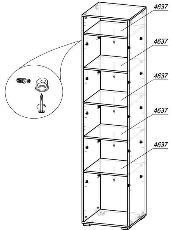
ШАГ 2. В полки 4637 установить стяжку-полкодержатель (по 4 шт на каждую), вставить полки в шкаф и закрепить дюбели, затянув стяжки.
