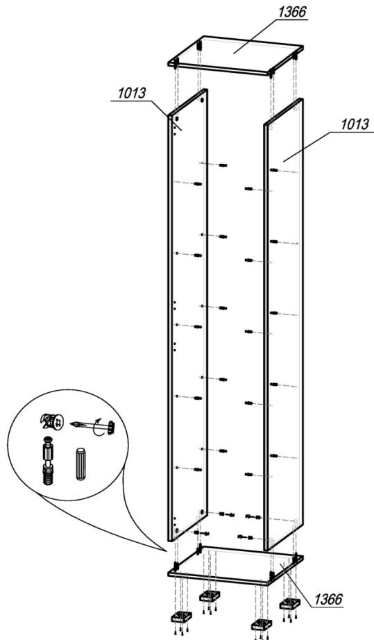
**ВНИМАНИЕ!** На первом этапе сборку конструкции осуществлять расположив детали на полу. Место должно быть ровным, чистым, достаточно просторным, чтобы не стеснять движений. Сборку лучше проводить ведоём.
