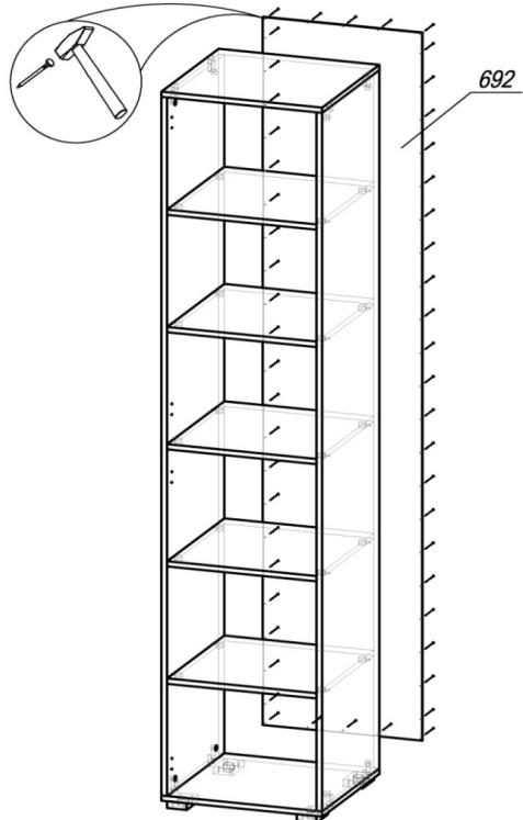
ШАГ 3. Сборка производится лицевой стороной вниз. Проверив рулеткой или рейкой равенство диагоналей, прибить гвоздями 2x20 заднюю стенку ЛДВП 692. Поднять шкаф и установить его на место.
