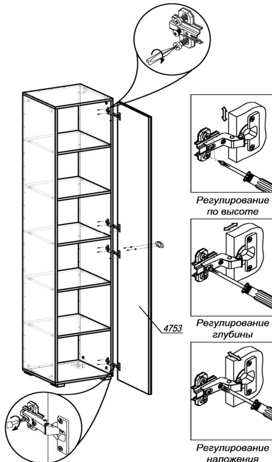
ШАГ 4. Разобрать петлю для накладной двери на две части (петлю и ответная планка петли). Вторую часть петли (ответная планка) прикрепить шурупами 4x16 к боку 1013. Подготовить створку 4753, закрепив первую часть петли шурупами. Навесить створку 4753 на накладные петли. Привернуть ручку винтами. Закрыть эксцентрики заглушками. Убедитесь, что шкаф стоит ровно. При необходимости выровняйте его с помощью регулировки опоры.
