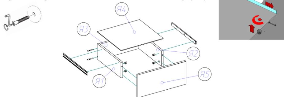
5. Устанавливаем ящики в корпус комода. На фасады устанавливаем ручки при помощи винтов (винты в комплекте с ручками) и шайб
