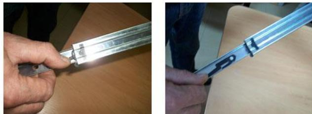
В отверстия на крышке (2) и горизонте (6) устанавливаем штоки стяжек эксцентриковых и забиваем шканты 8\*30. Важно: установка шкантов производится только на ровной твердой поверхности. Саморезами 3,5\*16 к стоевым (1,2) крепим широкие части направляющих и крепим опоры ко дну (4), как показано на рисунке
