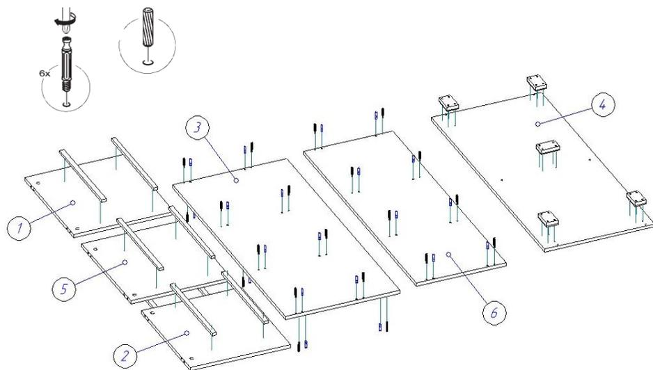
2. При помощи евровинтов 6,3\*50 ко дну (4) крепим стоевые (1,2,5), после чего к этим стоевым на стяжки эксцентриковые и шканты 8\*30 крепим крышку (3). Далее к
