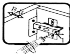
Если нижняя или верхняя часть фасада отстает от корпуса, нужно ослабить винт 1 и сдвинуть фасад в направлении В-В, а затем затянуть винт 1.
