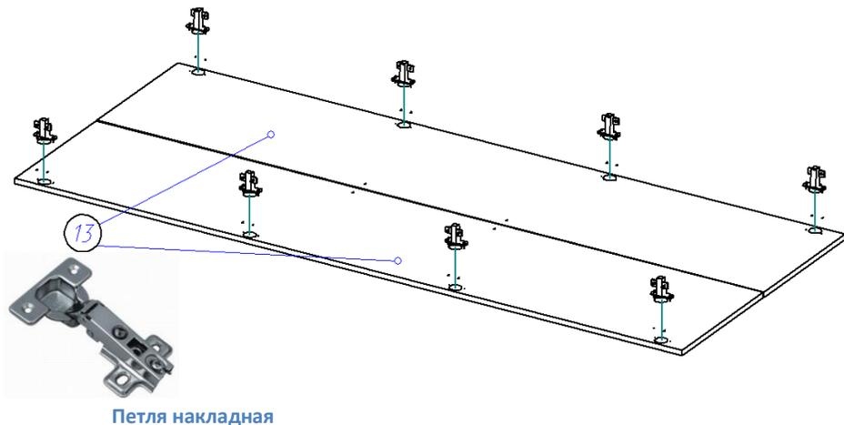
6. В отверстия на боках (1,2) устанавливаем полкодержатели и кладем на них полку (6).
