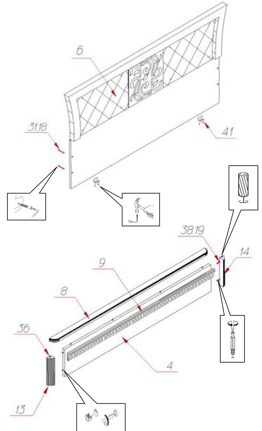
Винт вставляется в специальные отверстия в рамке кровати и фиксируется гайкой с обратной стороны
