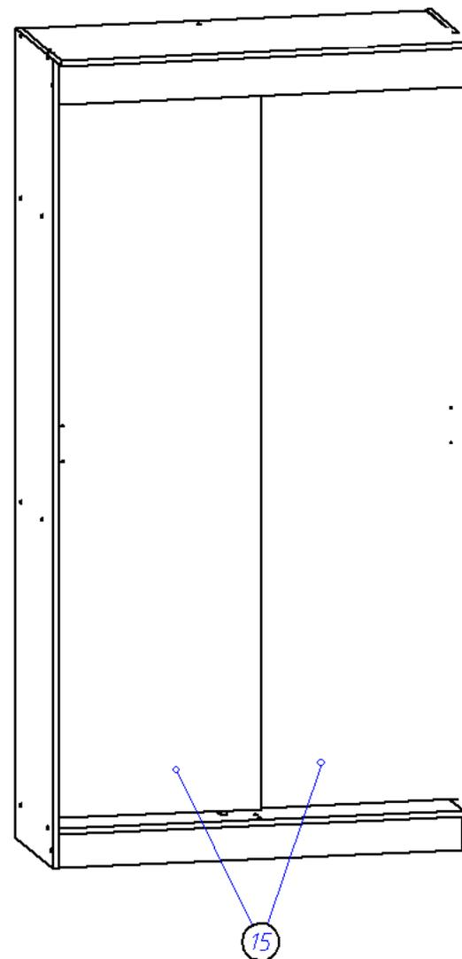
4. В отверстия на боку (12) и стойки (5) вставляем полкодержатели никель D5 и устанавливаем на них полки (14). К боку (11) и стойке (5) по наколам саморезами 3,5\*16 крепим скалкодержатели и устанавливаем деревянную скалку.
