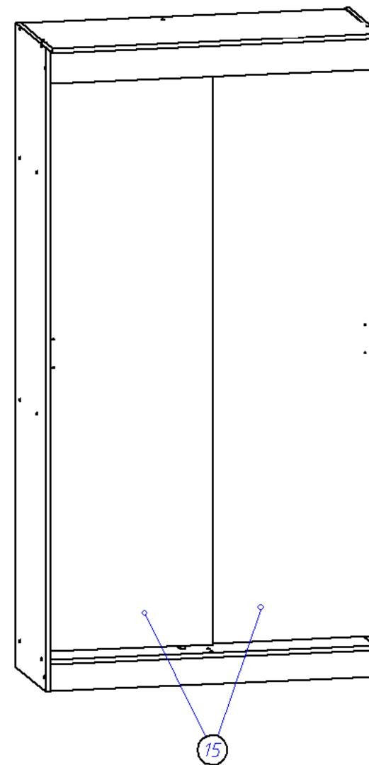
4. В отверстия на боку (12) и стойки (5) вставляем полкодержатели никель D5 и устанавливаем на них полки (14). К боку (11) и стойке (5) по наколам саморезами 3,5\*16 крепим скалодержатели и устанавливаем деревянную скалку.
