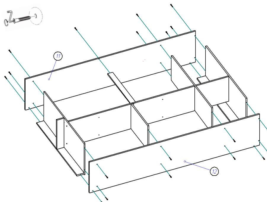
3. Гвоздями 1,2\*20 прибиваем задние стенки ДВП (13). Между панелями ДВП вставляем соединительный профиль. К нижним торцам боков и цоколей гвоздями 1,2\*20 прибиваем подпятники. Саморезами 3,5\*16 (4 шт) дополнительно крепим задние стенки (ДВП) к планке (7).
