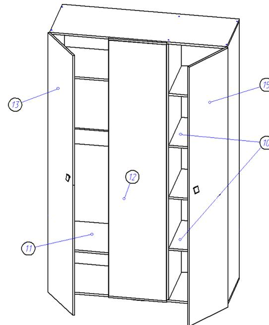
После того как навесили фасады, производится их регулировка согласно представленным схемам.
