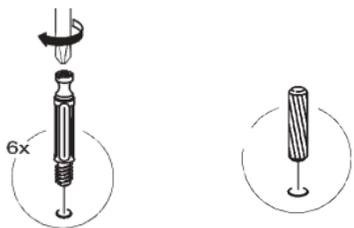
2. При помощи стяжек эксцентриковых, евроинтов 6,3\*50 и шкантов 8\*30 собираем конструкцию, что указана на рисунке, предварительно установив во фланцы трубу хром 25 мм.
