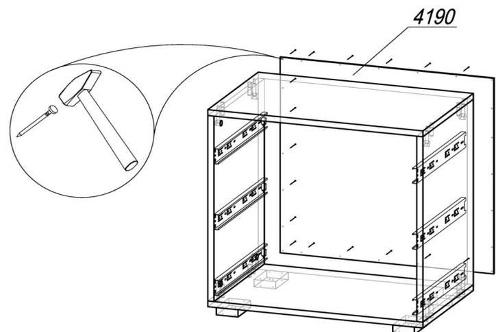
ШАГ 4. Далее сборка производится лицевой стороной вниз. Проверив рулеткой или рейкой равенство диагоналей, прибить гвоздями 2x20 заднюю стенку ЛДВП 4190. Поднять тумбу и установить на место.
