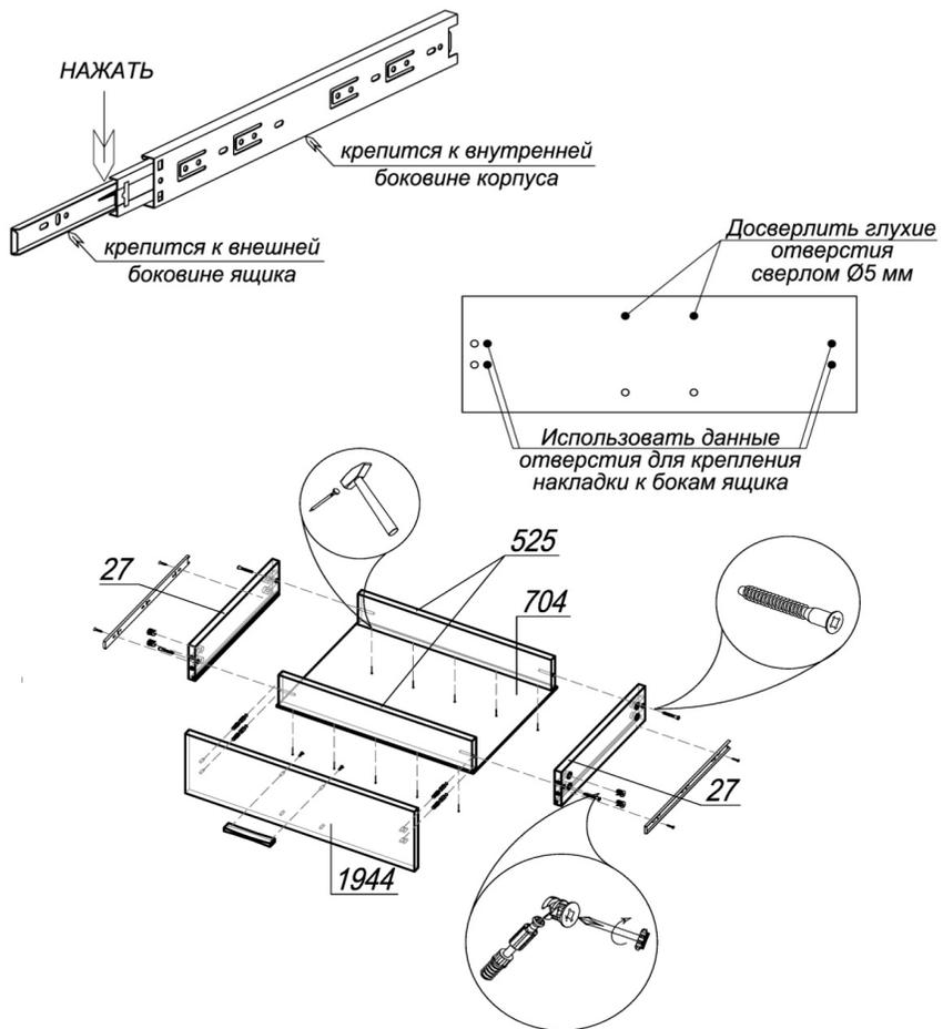
ШАГ 1. Перед началом сборки изделия подготовить направляющие полного выдвигения, разобрав их на две части. Для этого вытянуть внутреннюю планку до предела, нажать на деблокировочный рычаг и снять внутреннюю подвижную планку направляющих. Внешняя неподвижная планка крепится к внутреннему боку корпуса, внутренняя подвижная - к внешнему боку ящика. Сборка ящика.
