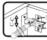
Если створка наклонена вправо или влево относительно вертикали корпуса, нужно выпрямить наклон створки в направлении A-A винтом 2.
