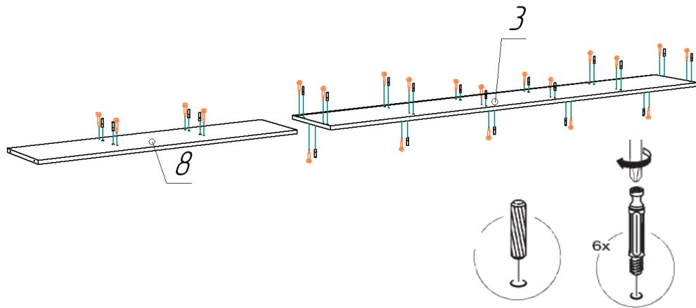
2. При помощи евровинтов 6,3\*50 крепим горизонт (8) к стоевым(9,10), далее к горизонту 8 на эксцентриковые стяжки и шканты ставим стоевые (5,6).
