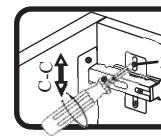
Если необходимо отрегулировать створку по высоте, нужно ослабить винт 3, отрегулировать створку в направлении C-C, а затем затянуть винт 3.
