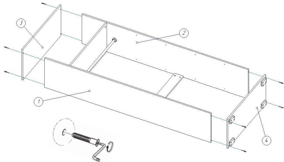
4. Переворачиваем корпус шкафа лицевой стороной вниз, выравниваем диагонали и гвоздями 1,2\*20 прибиваем задние стенки ДВП (8), предварительно установив между ними соединительный профиль.
