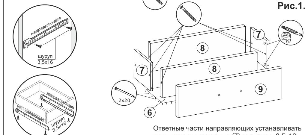
Ответные части направляющих устанавливать по центру детали ящика (7) шурупами 3,5x16. Ручки крепить к створке (9) шурупами 4x16 П/Ш, к створке (10) - шурупами 4x32 П/Ш.
