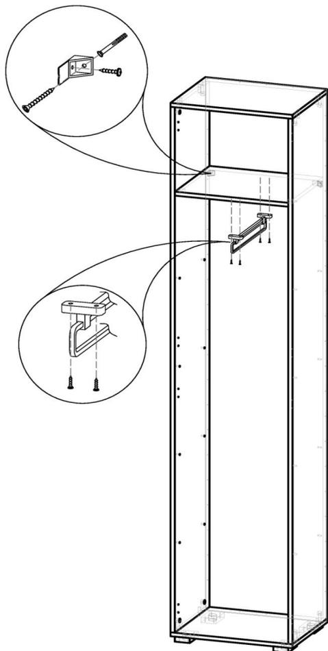
ШАГ 3. Шурупами 4x16 привернуть выдвижную штангу. Под полкой прикрепить уголки пластиковые 20x20 саморезами с прессшайбой 4x16 к бокам 1013, предварительно смонтировав дюбели в стену. Используя саморезы, закрепить шкаф к стене через уголки и ЛДВП.
