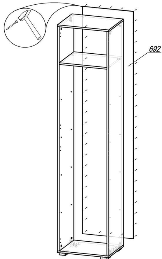
ШАГ 2. Сборка производится лицевой стороной вниз. Проверьте рулеткой или рейкой равенство диагоналей, прибить гвоздями 2x20 заднюю стенку ЛДВП 692. Поднять шкаф и установить его на место.
