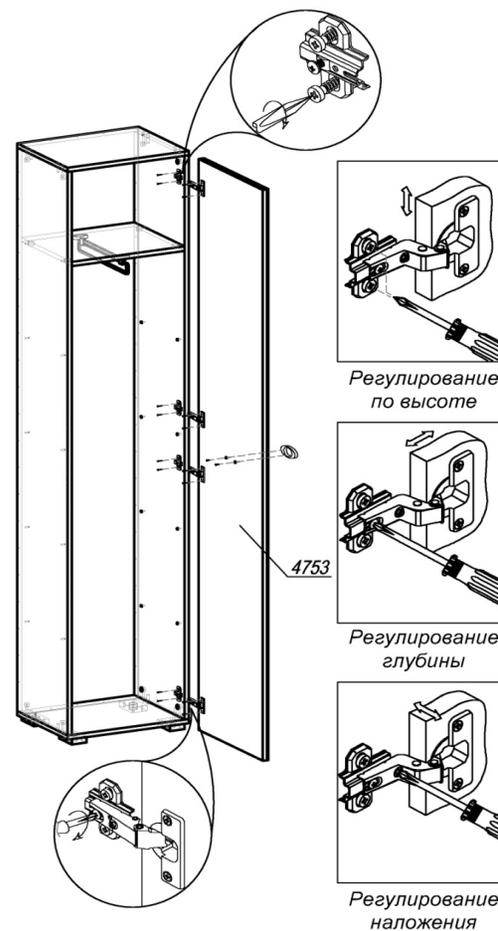
ШАГ 4. Разобрать петлю для накладной двери на две части (петля и ответная планка петли). Закрепить первую часть петли шурупами 4x16 на створке 4753. Вторую часть петли (ответная планка) прикрепить шурупами 4x16 к боку 1013. Навесить створку на накладные петли. Привернуть ручку винтами. Закрыть эксцентрики и открытые отверстия соответствующими заглушками. При необходимости выровнять шкаф с помощью регулировки опор.
