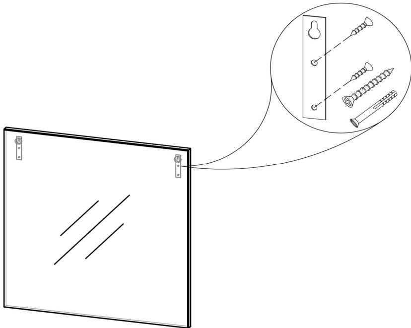
Привернуть к щиту 5093 2 плоских навеса с помощью шурупов 4x16. Навесить конструкцию на дюбель-гвозди, вмонтированные в стену.
