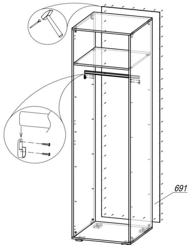
ШАГ 3. Сборка производится лицевой стороной вниз. Проверив рулеткой или рейкой равенство диагоналей, прибить гвоздями 2х20 заднюю стенку ЛДВП 691. Поднять шкаф и установить его на место. Шурупами 4х16 привернуть штангодержатели, поставить штангу.
