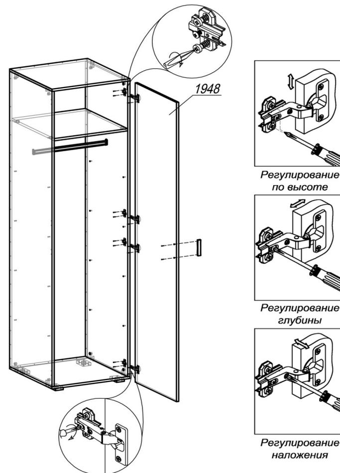
ШАГ 4. Разобрать петлю для накладной двери на две части (петля и ответная планка петли). Закрепить первую часть петли шурупами 4х16 на створке 1948. Вторую часть петли (ответная планка) прикрепить шурупами 4х16 к боку 1014. Навесить створку на накладные петли. Досверлить отверстия Ø5 мм в створке и привернуть ручку шурупами 4х30. Закреть эксцентрики и открытые отверстия соответствующими заглушками.
