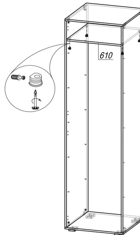
ШАГ 2. В полку 610 установить стяжку-полкодержатель (4 шт), вставить полку в шкаф и закрепить дюбели, затянув стяжки.
