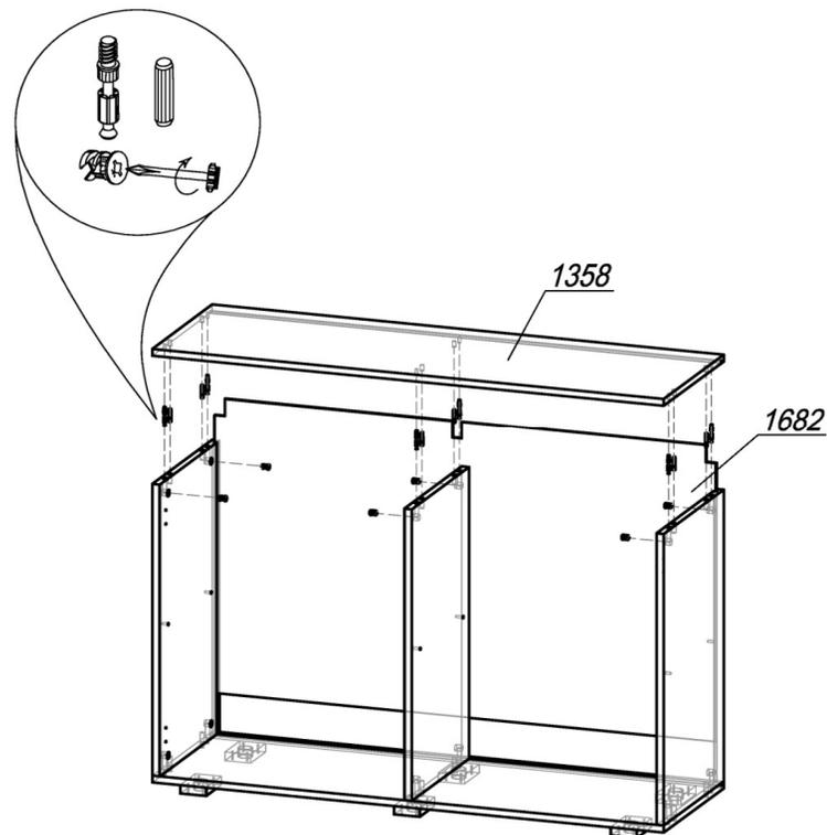
ШАГ 2. ЛДВП 1682 вставить в пазы боков 1047, задвинуть до упора в крышку 1358. Соединить подготовленную крышку 1358 с боками 1047 и 1050, установить эксцентрик Minifix (6 шт) и закрепить шток эксцентрика.
