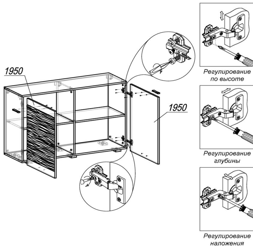
ШАГ 4. Разобрать петлю для накладной двери на две части (петля и ответная планка петли). Закрепить первую часть петли шурупами 4x16 на створках 1950. Вторую часть петли (ответная планка) прикрепить шурупами 4x16 к бокам 1047. Навесить створки на накладные петли. Досверлить отверстия  $\varnothing 5$ мм в створках и привернуть ручки шурупами 4x30. Закрывать эксцентрики и открытые отверстия соответствующими заглушками.
