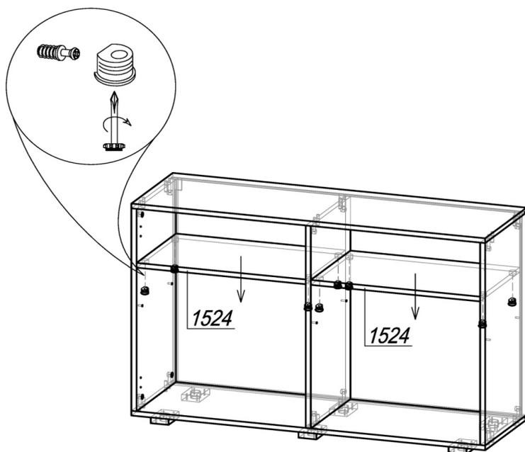
ШАГ 3. В полки 1524 установить стяжку-полкодержатель (по 4 шт в деталь), вставить полки в корпус и закрепить дюбели, затянув стяжки. Проверив рулеткой или рейкой равенство диагоналей, прибить гвоздями 2x20 ЛДВП к полкам.
