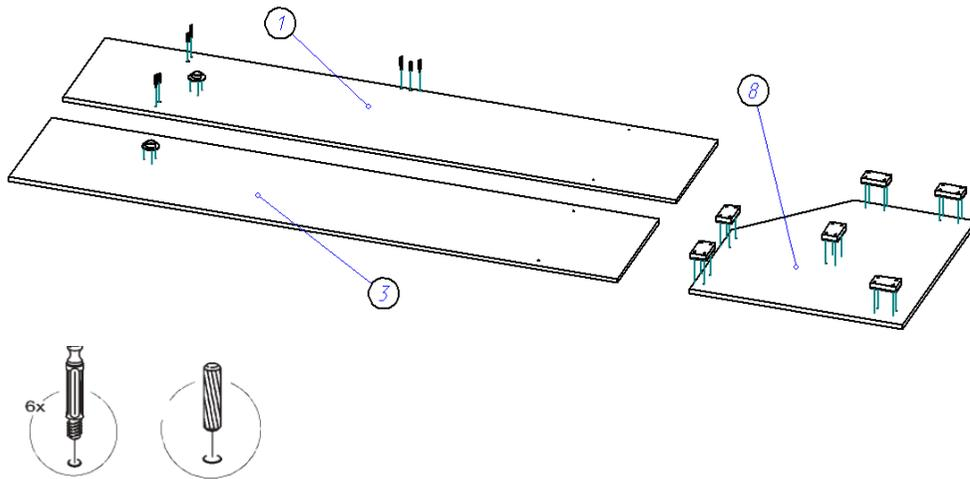
2. При помощи евроинтов 6,3\*50, стяжек эксцентриковых и шкантов 8\*30 соединяем бок (1) и стоевую (3) с горизонтом (5) и распоркой (6), предварительно установив трубу хром 25 мм в скалкодержатели.
