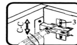
Если необходимо отрегулировать фасад по высоте, нужно ослабить винт 3, отрегулировать фасад в направлении С-С, а затем затянуть винт 3.
