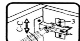
Если необходимо отрегулировать фасад по высоте, нужно ослабить винт 3, отрегулировать фасад в направлении С-С, а затем затянуть винт 3.
