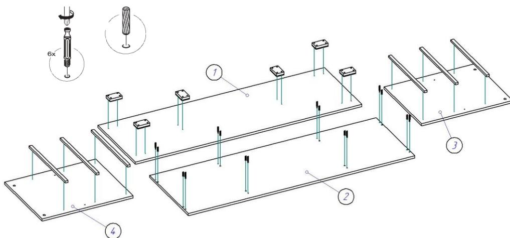
2. При помощи евровинтов 6,3\*50 ко дну (1) крепим стоевые (3,4,5,6), после чего к этим стоевым на стяжки эксцентриковые и шканты 8\*30 крепим крышку (2).
