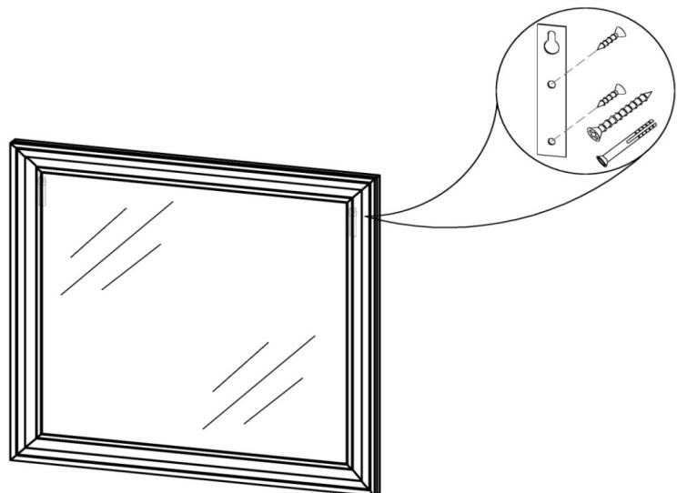
**Привернуть к щиту 4714 2 плоских навеса с помощью шурупов 4x16. Навесить конструкцию на дюбель-гвозди, вмонтированные в стену.**
