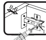
Если нижняя или верхняя часть створки отстает от корпуса, нужно ослабить винт 1 и сдвинуть створку в направлении B-B, а затем затянуть винт 1.
