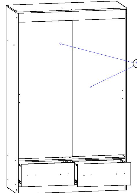
5. Гвоздями 1,2\*20 прибиваем задние стенки ДВП (13,14). Между панелями (13) устанавливаем соединительный профиль ДВП. Дополнительно саморезами 3,5\*16 (4 шт) крепим панели (13) к планке (8).
