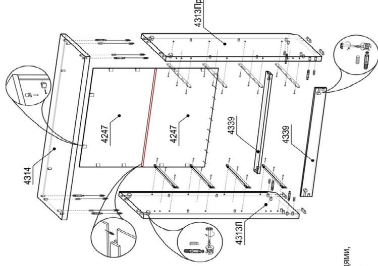
**ШАГ 3.** Перевернуть изделие лицевой частью в низ. Первое ЛДВП **4247** вставляем в пазы боков **4313Л** и **4313Пр** и задвигаем до упора в крышку **4314**. Установить брус соединительный и второе ЛДВП **4247**. Проверить диагональ изделия, и закрепить второе ЛДВП **4247** к вязке **4339** гвоздями. Установить фиксатор задней стенки с помощью шурупа **4x20**.
