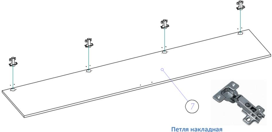
6. В отверстия на боках устанавливаем полкодержатели и кладем на них полку (8).
