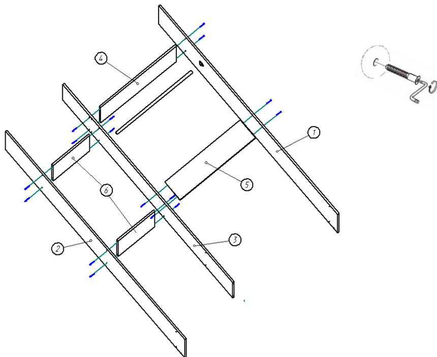
3. К бокам (1,2) и стоевой (3) при помощи евровинтов и ключа для них прикручиваются крыша (7) и дно (8). В цоколь (9) в отверстие вбивается шкант 8\*30 (установку шканта необходимо проводить на твердой ровной поверхности во избежание порчи детали) и цоколь (10) присоединяется к цоколю (9). Цоколя (9,10) крепятся ко дну евровинтами и ключа для них. В торец боковин (1,2) и цоколя (10) при помощи гвоздей 1,2\*20 прибиваются подпятники.
