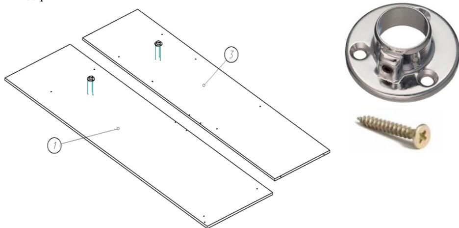
2. Сборка шкафа для удобства производится лицевой стороной вниз. К бокам (1,2) и стоевой (3) при помощи евровинтов и ключа для них прикручиваются распорка (5) и горизонты (4,6). В скалкодержатели вставляется труба хром 25 мм.
