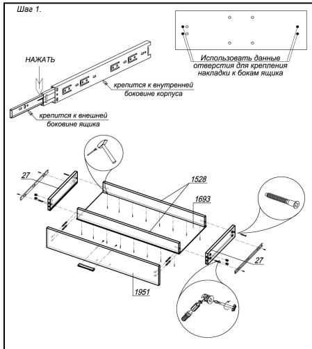
ШАГ 1. Перед началом сборки изделия подготовить направляющие полного выдвижения, разобрав их на две части. Для этого вытянуть внутреннюю планку до предела, нажать на деблокировочный рычаг и снять внутреннюю подвижную планку направляющих. Внешняя неподвижная планка крепится к внутреннему боку корпуса, внутренняя подвижная - к внешнему боку ящика. Сборка ящика.
