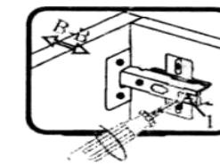
Если фасад наклонен вправо или влево относительно вертикали корпуса, нужно выправить наклон фасада в направлении А-А винтом 2.
