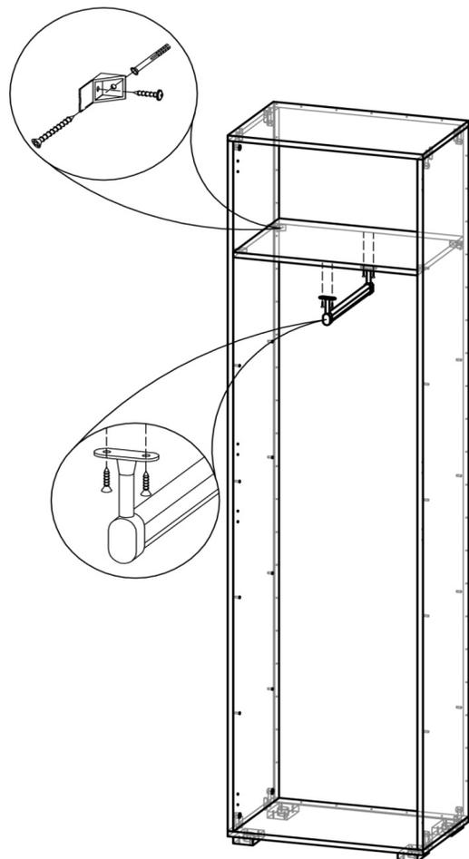
ШАГ 3. Вставить штангу в штангодержатели и шурупами 4x16 привернуть к полке. Под полкой прикрепить уголки пластиковые 20x20 саморезами с прессшайбой 4x16 к бокам 1013, предварительно вмонтировав дюбели в стену. Используя саморезы, закрепить шкаф к стене через уголки и ЛДВП.
