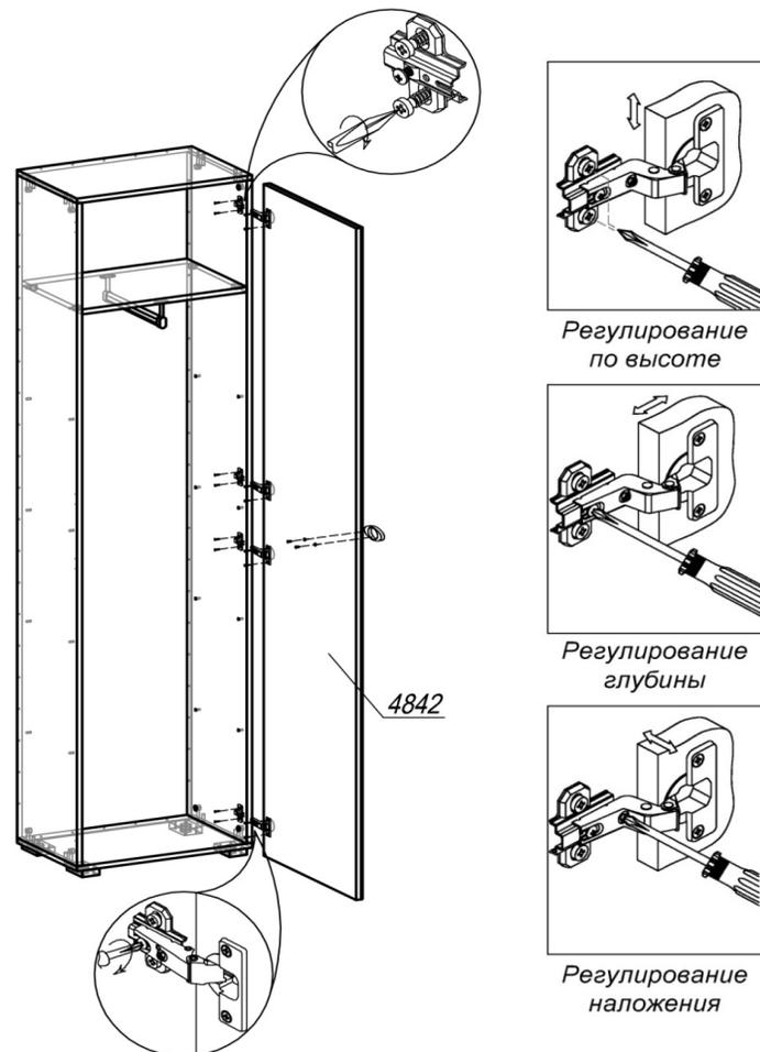
ШАГ 4. Разобрать петлю для накладной двери на две части (петля и ответная планка петли). Закрепить первую часть петли шурупами 4x16 на створке 4842. Вторую часть петли (ответная планка) прикрепить шурупами 4x16 к боку 1013. Навесить створку на накладные петли. Привернуть ручку винтами. Закрыть эксцентрики и открытые отверстия соответствующими заглушками.
