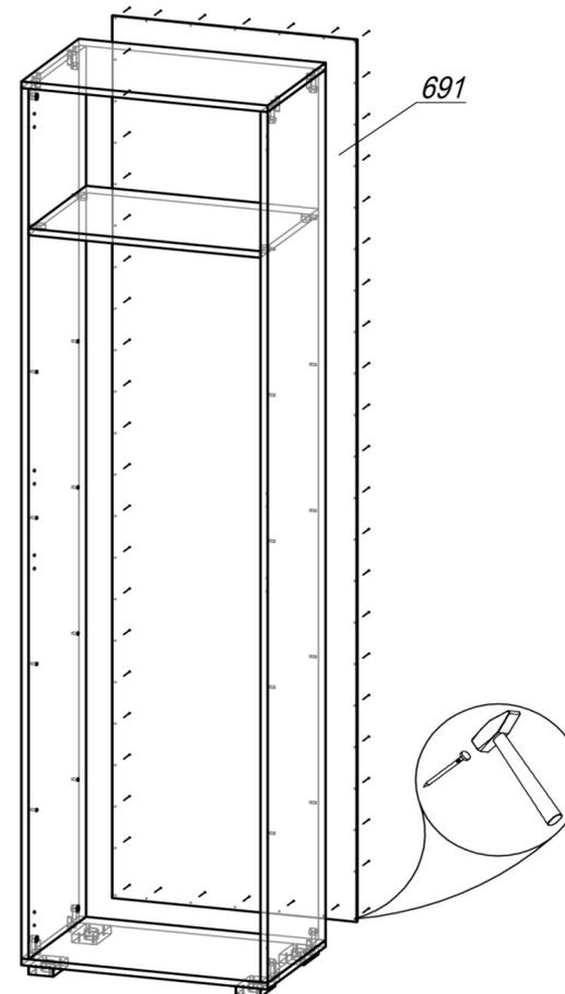
ШАГ 2. Сборка производится лицевой стороной вниз. Проверив рулеткой или рейкой равенство диагоналей, прибить гвоздями 2x20 заднюю стенку ЛДВП 691. Поднять шкаф и установить его на место.
