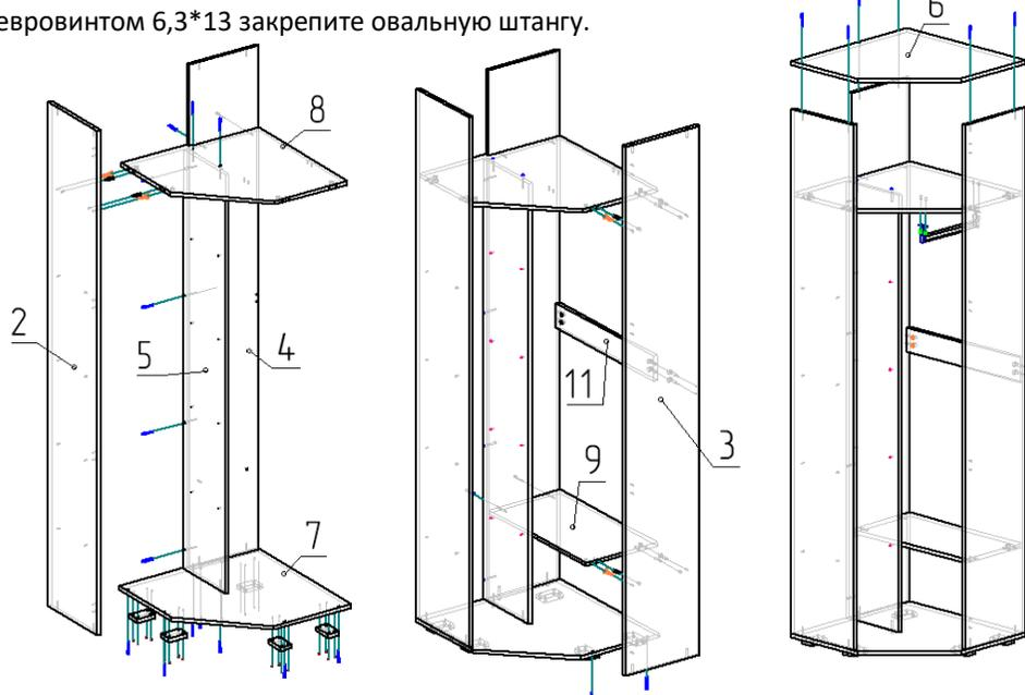
2) Переверните шкаф лицевой стороной к полу и прибейте задние стенки ДВП (17,27) и (16, 23) гвоздями 1,2\*20, предварительно вставив между (17) соединительный профиль для ДВП (21, 20, 19).
