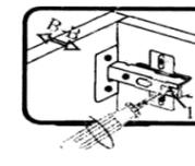
Если нижняя или верхняя часть фасада отстает от корпуса, нужно ослабить винт 1 и сдвинуть фасад в направлении В-В, а затем затянуть винт 1.
