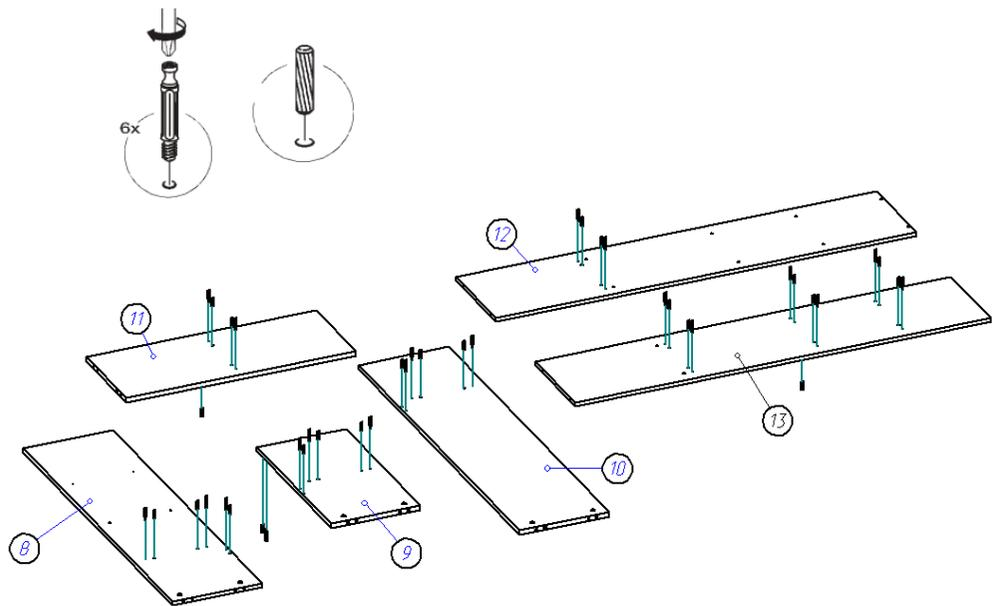
5. С помощью стяжек эксцентриков и шкантов к горизонту (11) крепим стоевую (15) и фронтальную панель (14). После этого к горизонту (11) и панели (14) крепим стоевые (8,9).
