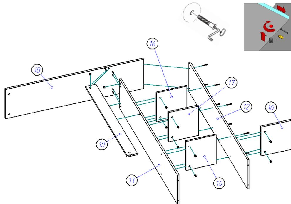
7. Используя евроинты, стяжку эксцентрик и шкант, соединяем конструкции, полученные в пунктах 5 и 6. К стоевым (8,15,16) евроинтами прикручиваем крышку (19).
