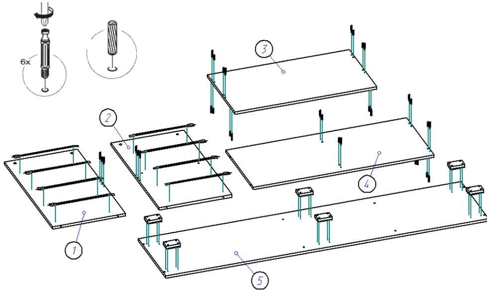
2. При помощи стяжек эксцентриковых и шкантов соединяем бока (1,2) с распоркой (6). Далее к боку (2) евровинтами 6,3\*50 крепим крышку (4).
