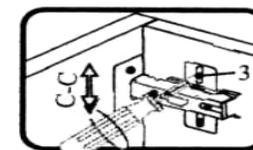
Если необходимо отрегулировать фасад по высоте, нужно ослабить винт 3, отрегулировать фасад в направлении С-С, а затем затянуть винт 3.
