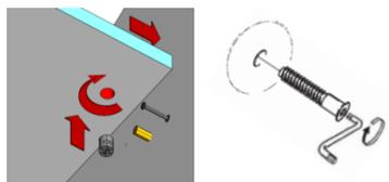
3. С помощью стяжек эксцентриковых и шкантов к крышке (4) крепим стоевые (7). К полученной конструкции евроинтами прикручиваем дно (5). Далее к бокам (1,2) крепим крышку (3).
