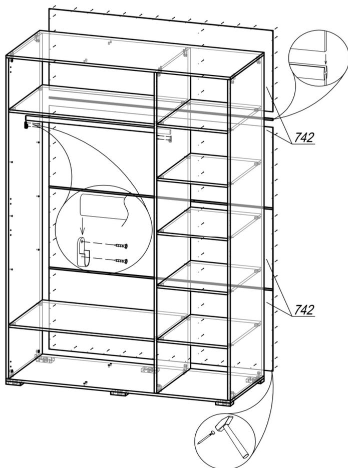
ШАГ 3. Сборка производится лицевой стороной вниз. Проверив рулеткой или рейкой равенство диагоналей, прибить гвоздями 2x20 заднюю стенку ЛДВП 742 (1 деталь). Установить соединительный брус, следом задвинуть 2-ую деталь ЛДВП 742 и прибить гвоздями. Аналогично поступить с 3-ей и 4-ой деталями ЛДВП 742. Поднять шкаф и установить его на место. Шурупами 4x16 привернуть штангодержатели, поставить штангу.
