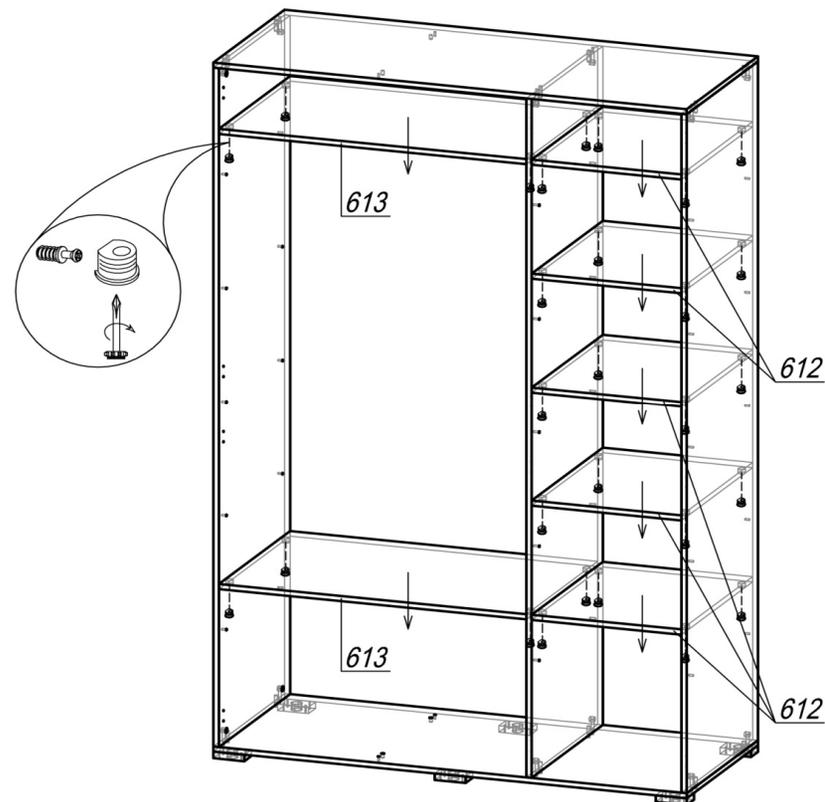
ШАГ 2. В полки 612 и 613 установить стяжку-полкодержатель (по 4 шт), вставить полки в шкаф и закрепить дюбели, затянув стяжки.
