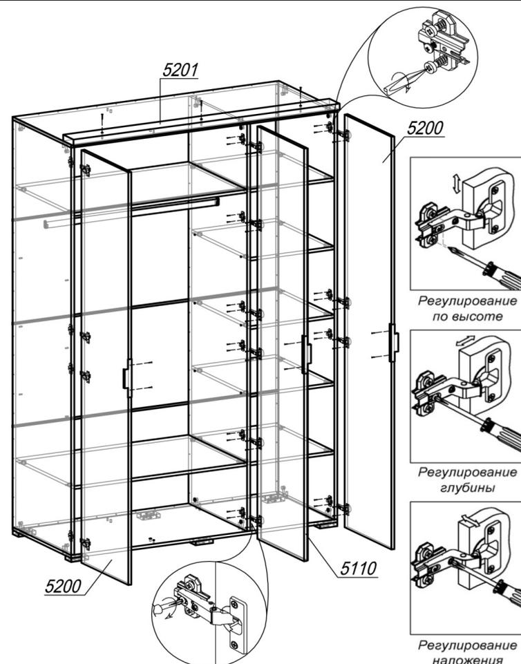
ШАГ 4. Разобрать петлю на две части (петля и ответная планка петли). Закрепить первую часть петли шурупами 4x16 на створках 5110 и 5200 (полунакладные петли установить на створку с зеркалом). Вторую часть петли (ответная планка) прикрепить шурупами 4x16 к бокам 1014 и 5199. Навесить створки на петли. Привернуть ручки шурупами 4x16. Саморезами 3,5x45 привернуть планку 5201 к крышке 5198 с вылетом 20 мм. Закрыть эксцентрики и открытые отверстия соответствующими заглушками.
