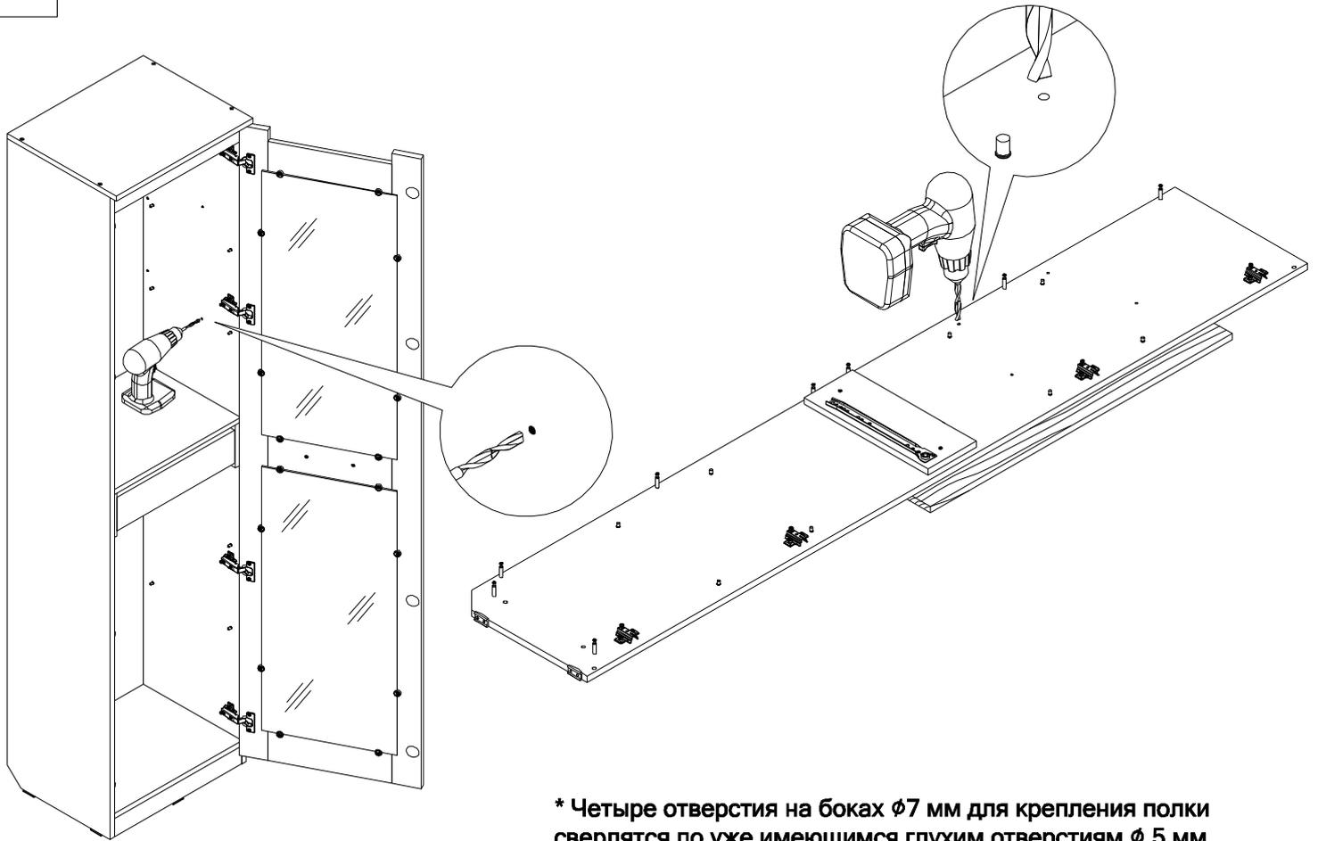
\* Четыре отверстия на боках  $\phi 7$  мм для крепления полки сверлятся по уже имеющимся глухим отверстиям  $\phi 5$  мм
