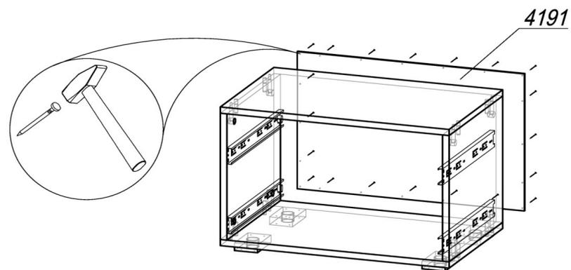
ШАГ 4. Далее сборка производится лицевой стороной вниз. Проверив рулеткой или рейкой равенство диагоналей, прибить гвоздями 2x20 заднюю стенку ЛДВП 4191. Поднять тумбу и установить на место.
