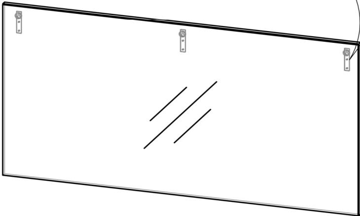
Привернуть к щиту 5094 3 плоских навеса с помощью шурупов 4x16. Навесить конструкцию на дюбель-гвозди, вмонтированные в стену.
