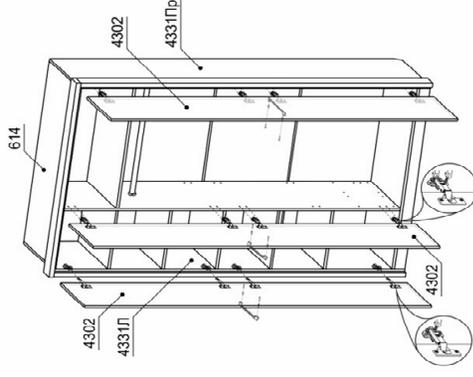
**ШАГ 3.** Подготовить две створки 4302 (которые крепятся к бокам 4331П и 4331Пр, прикрепив первую часть разобранной накладной петли шурупами 4x16 к створке. На третью створку 4302 прикрепить 4 вкладные петли шурупами 4x16. Прикрепить створки к бокам. Установить ручки на створки 4302 с помощью винтов 4x25. При необходимости отрегулировать петли.
