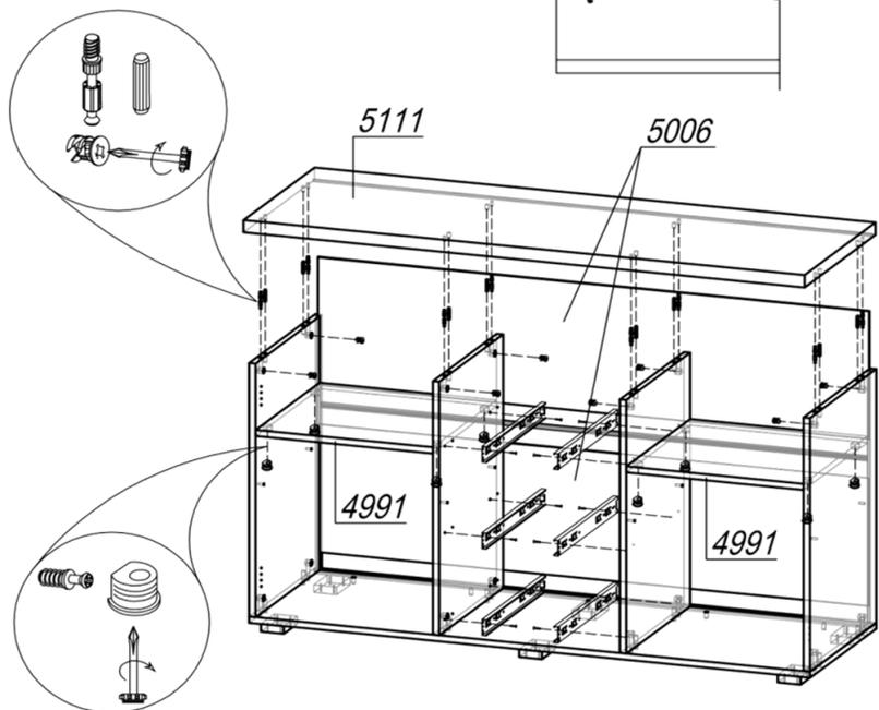
ШАГ 3. К бокам 5004 прикрепить внешнюю неподвижную планку направляющих шурупами 4x13. В полки 4991 установить стяжку-полкодержатель (по 4 шт в деталь), вставить полки в тумбу и закрепить дюбели, затянув стяжки. ЛДВП 5006 (1 деталь) вставить в пазы боков 5003, задвинуть до упора в крышку 4934. Установить соединительный брус, следом задвинуть 2-ую деталь ЛДВП 5006. Соединить подготовленную крышку 5111 с боками 5003 и 5004, установить эксцентрик Minifix (8 шт) и закрепить шток эксцентрика.
