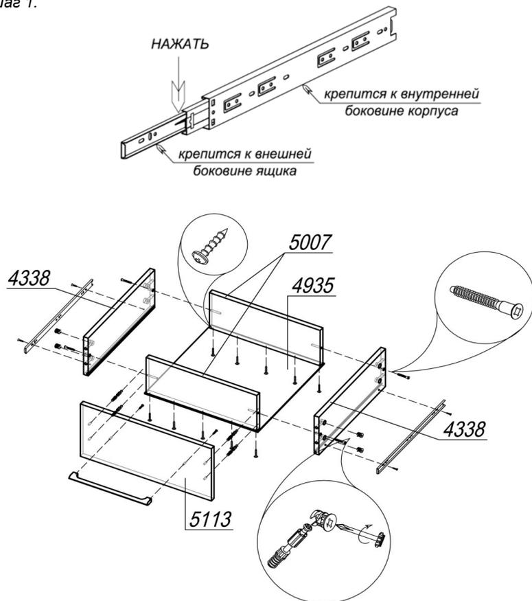
ШАГ 1. Перед началом сборки изделия подготовить направляющие полного выдвижения, разобрав их на две части. Для этого вытянуть внутреннюю планку до предела, нажать на деблокировочный рычаг и снять внутреннюю подвижную планку направляющих. Внешняя неподвижная планка крепится к внутреннему боку корпуса, внутренняя подвижная - к внешнему боку ящика.
