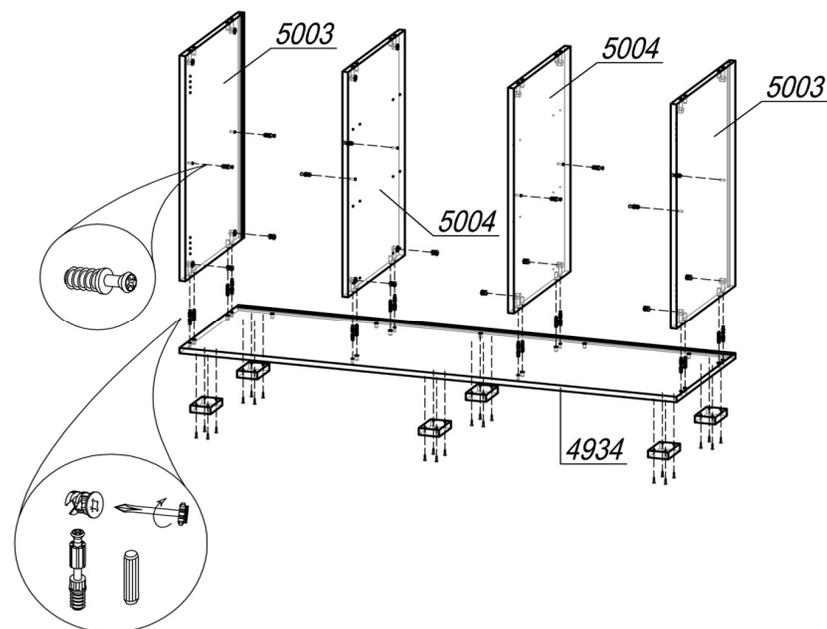
ШАГ 2. Подготовить крышки 5111 и 4934 к сборке: предварительно к нижней крышке шурупами 4x16 привернуть опоры L-20 (6 шт); установить шток эксцентрика (по 8 шт в деталь) в глухие отверстия Ø5мм и шкант (по 8 шт в деталь) в глухие отверстия Ø8мм. В бока 5003 и 5004 в отверстия Ø5мм установить дюбель-полкодержатель (по 2 шт) для крепления полок 4991. Затем, соединив крышку 4934 с боками 5003 и 5004, установить эксцентрик Minifix (8 шт) и закрепить шток эксцентрика.
