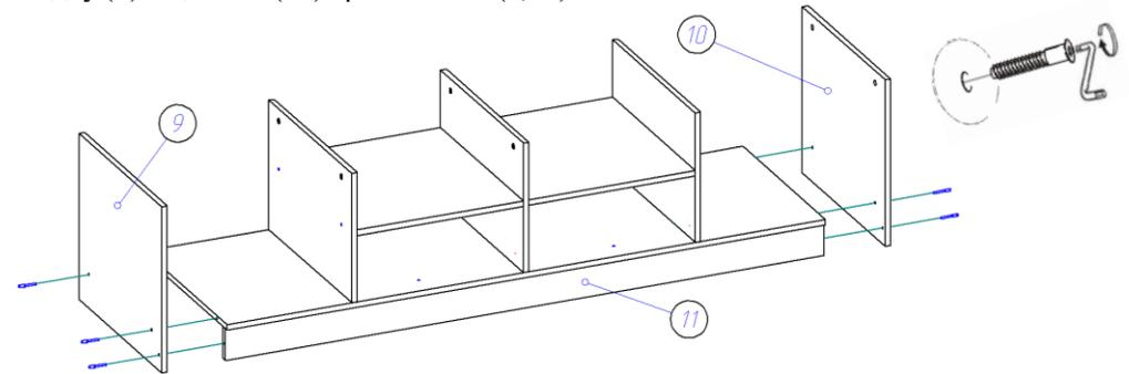
5. При помощи евровинтов 6,3\*50 собираем конструкцию, как показано на схеме.
