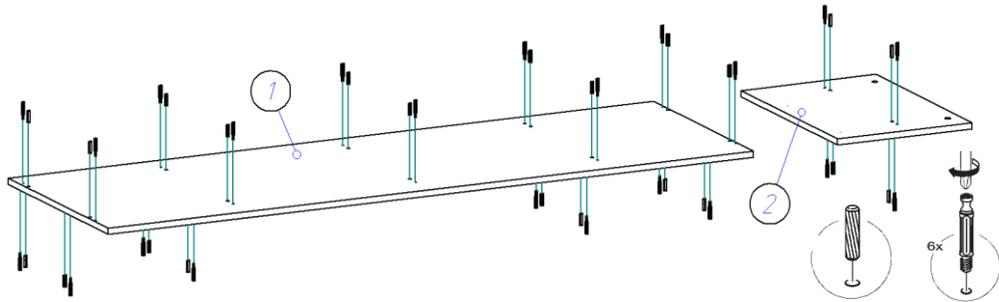
2. При помощи евровинтов 6,3\*50, стяжек эксцентриковых и шкантов 8\*30 крепим горизонты (5,6) к стоевым (2,3,4). К стоевым (3,4) саморезами 3,5\*16 крепим роликовые направляющие.
