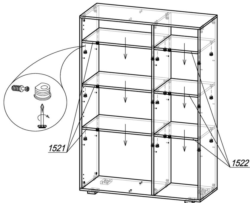
ШАГ 2. В полки 1521 и 1522 установить стяжку-полкодержатель (по 4 шт в деталь), вставить полки в шкаф и закрепить дюбели, затянув стяжки.
