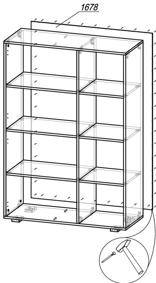
ШАГ 3. Сборка производится лицевой стороной вниз. Проверив рулеткой или рейкой равенство диагоналей, прибить гвоздями 2х20 заднюю стенку ЛДВП 1678. Поднять шкаф и установить его на место.
