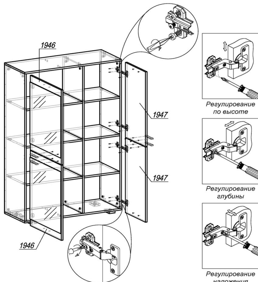
ШАГ 4. Разобрать петлю для накладной двери на две части (петля и ответная планка петли). Закрепить первую часть петли шурупами 4х16 на створках 1946 и 1947. Вторую часть петли (ответная планка) прикрепить шурупами 4х16 к бокам 1045. Навесить створки на накладные петли. Досверлить отверстия  $\varnothing 5$  мм на створках и привернуть ручки шурупами 4х30. Закрывать эксцентрики и открытые отверстия соответствующими заглушками.
