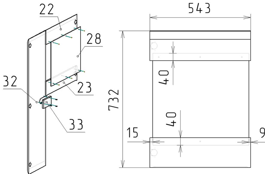
6. Установить стекла (29) на боковины шкафа при помощи саморез 3,5\*16 через прозрачную шайбу. Далее установить полкодержатели в боковины шкафа.
