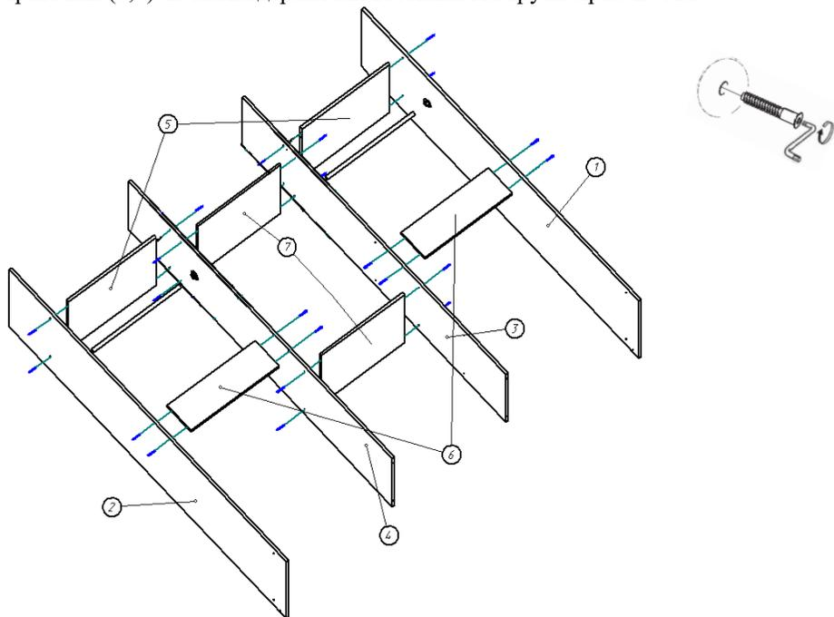
3. К бокам (1,2) и стоевым (3,4) при помощи евроинтов и ключа для них прикручиваются крыша (8) и дно (9). В цоколь (10) в отверстие вбивается шкант 8\*30 (установку шканта необходимо проводить на твердой ровной поверхности во избежание порчи детали) и цоколь (11) присоединяется к цоколю (10). Цоколя (10,11) крепятся ко дну евроинтами и ключа для них. В торец боковин (1,2) и цоколя (11) при помощи гвоздей 1,2\*20 прибиваются подпятники.
