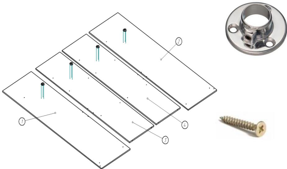
2. Сборка шкафа для удобства производится лицевой стороной вниз. К бокам (1,2) и стоевым (3,4) при помощи евроинтов и ключа для них прикручиваются распорки (6) и горизонты (5,7). В скалкодержатели вставляются трубы хром 25 мм.
