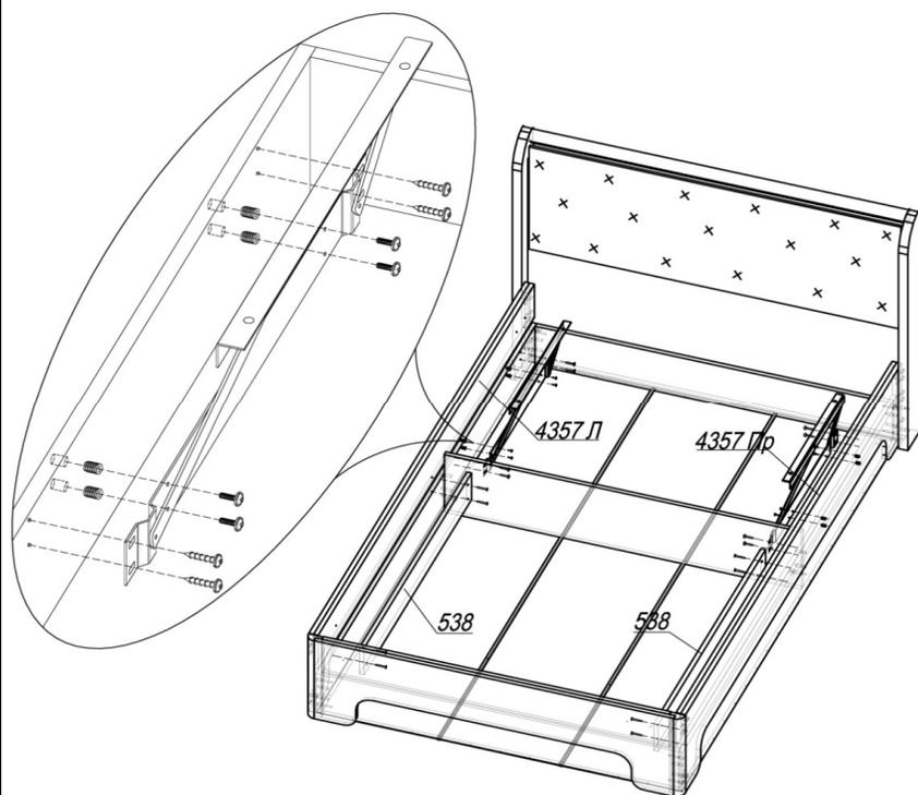
**ШАГ 3.** Соединить бельевой ящик и короб из боков с помощью вязки 538 шурупами 4x30. Вбить в бока 4357Л и 4357Пр по 4 Hettich-муфты, прикрепить подъемные механизмы к бокам ящика посредством саморезов с прессшайбой и Hettich-винтов.
