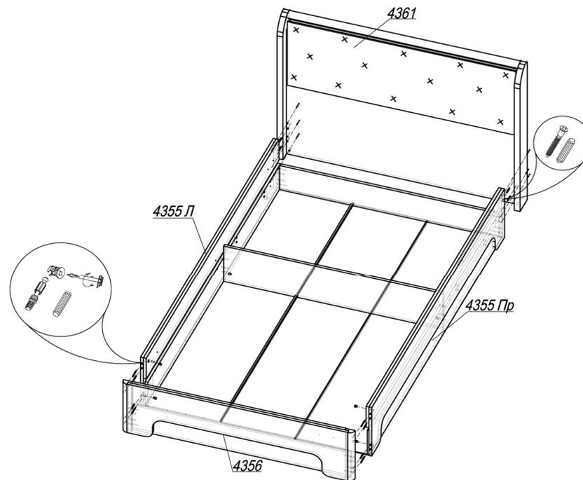
**ШАГ 2.** К бокам и щиту прибить подпятники гвоздями 2x20. Подготовить бок 4356 к сборке: вставить 4 штока эксцентрика (в отверстия Ø5 мм) и 4 шканта (в отверстия Ø8 мм). Соединить бок 4356 с боками 4355Л и 4355Пр вокруг ящика, установить эксцентрик MiniFix (по 2 шт в деталь) и закрепить шток эксцентрика. Задвинуть короб из боков 4355Л, 4355Пр и 4356 до упора в ящик. Вставить в бока 4355Л и 4355Пр по 2 шканта (в отверстия Ø8 мм), соединить с щитом 4361 и зафиксировать с помощью 6 евровинтов.
