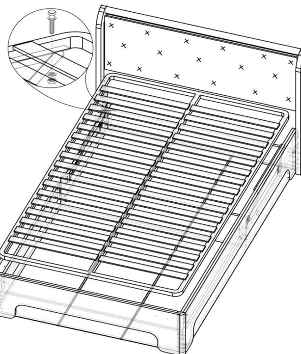
**ШАГ 4.** Положить ортопедическую решетку, соединить с подъемным механизмом, используя болты, шайбы и гайки. Установить газовые амортизаторы согласно приложенной инструкции.
