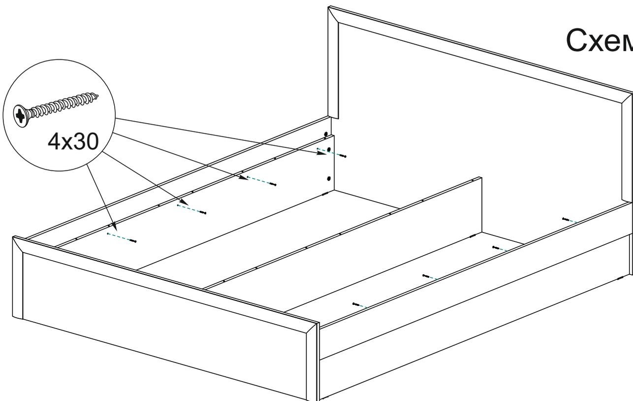
5. После сборки каркаса кровати, для придания конструкции жесткости, соедините между собой царги №1 и №2 с настилом №6 евроинтами, как показано на схеме 4.
