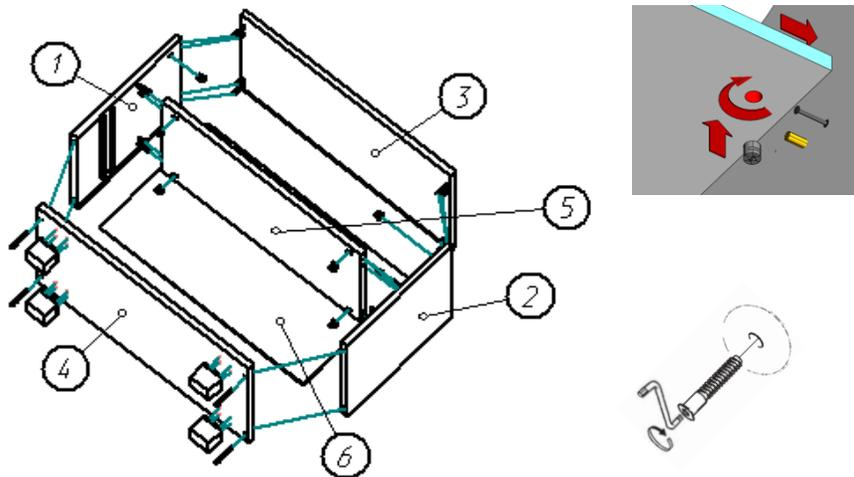
3. Собираем детали ящиков. Евровинтами 6,3\*50 прикручиваем бока ящика к фальш-панели ящика и панели ящика, прибиваем гвоздями 1,2\*20 дно ящика (ДВП). С помощью эксцентриковой стяжки крепим фасад ящика (Я5) к корпусу ящика. Саморезами 3,5\*16 на боках ящика крепим направляющие. Устанавливаем ящики в корпус тумбы.
