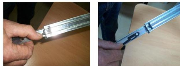
По наколам на боках (1,2) саморезами 3,5\*16 прикручиваются широкие части направляющих. По отверстиям на боках (1,2) и крыше (3) вкручиваются штоки эксцентриковых стяжек и забиваются шканты 8\*30. Установку шкантов необходимо проводить на твердой ровной поверхности во избежание порчи детали.
