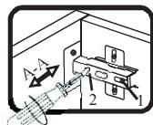
Если створка наклонена вправо или влево относительно вертикали корпуса, нужно выпрямить наклон створки в направлении А-А винтом 2.
