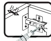
Если нижняя или верхняя часть створки отстает от корпуса, нужно ослабить винт 1 и сдвинуть створку в направлении В-В, а затем затянуть винт 1.
