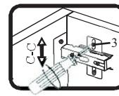
Если необходимо отрегулировать створку по высоте, нужно ослабить винт 3, отрегулировать створку в направлении С-С, а затем затянуть винт 3.
