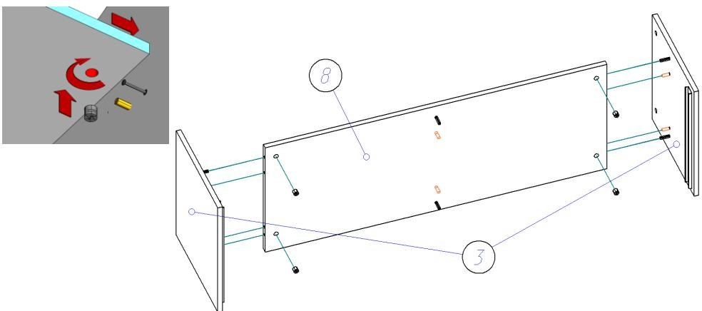
7. Евровинтами к горизонту (8) крепим стоевую (18). При помощи шкантов и стяжек эксцентриковых к горизонту (8) крепим стоевую (10), крышку (4) к бокам (3) и стоевой (18). Евровинтами дно (11) крепим к бокам (3) и стоевой (18).
