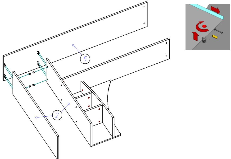
13. При помощи шкантов и стяжек эксцентриковых крепим бока (2) к крышке (4). Стоевая (7) совмещается со шкантами без стяжек.
