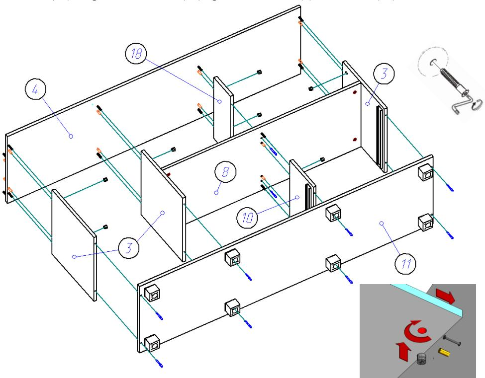
8. Проверяем диагональ полученной конструкции и с тыльной стороны гвоздями прибиваем задние стенки ДВП (19, 20).
