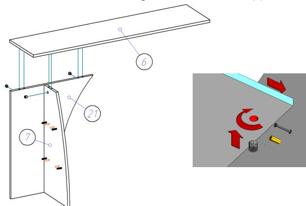
11. При помощи шкантов и стяжек эксцентриковых к стоевой (7) крепим горизонты (22, 23), затем к панели (21) и горизонтам (6, 22, 23) крепим бок (2).
