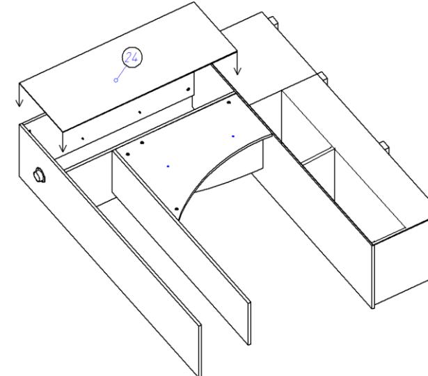
15. При помощи шкантов и стяжек эксцентриковых крепим крышку (5) и горизонт (6) к боку (1). Между крышками (5) и (9) во фланцы вставляем хромированную трубу (27).
