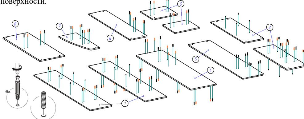
2. При помощи саморезов 3,5\*16 по наколам к бокам (3) и стоевой (10) прикручиваем направляющие, к крышкам (5, 9) прикручиваем хромированные фланцы, к дверям (13, 14, 15) прикручиваем петли. В отверстия на дне (5,6) вставляем опоры «американки».
