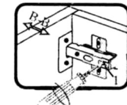
Если нижняя или верхняя часть фасада отстает от корпуса, нужно ослабить винт 1 и сдвинуть фасад в направлении В-В, а затем затянуть винт 1.
