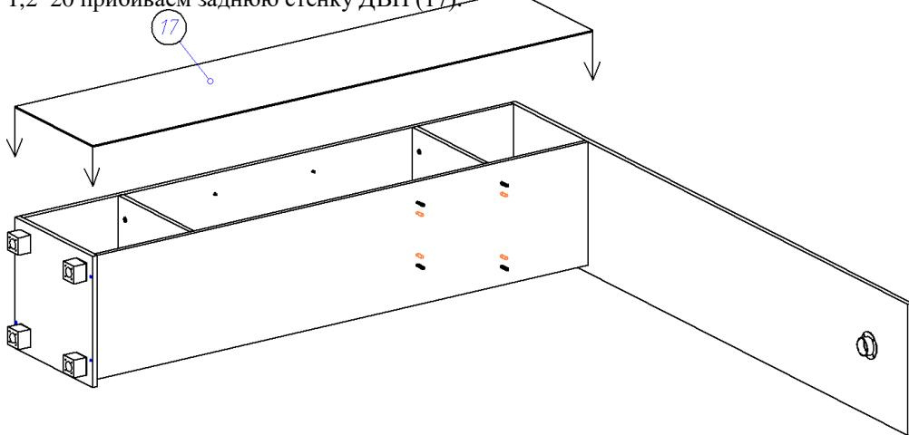
6. При помощи шкантов и стяжек эксцентриковых к горизонту (8) крепим бока (3).
