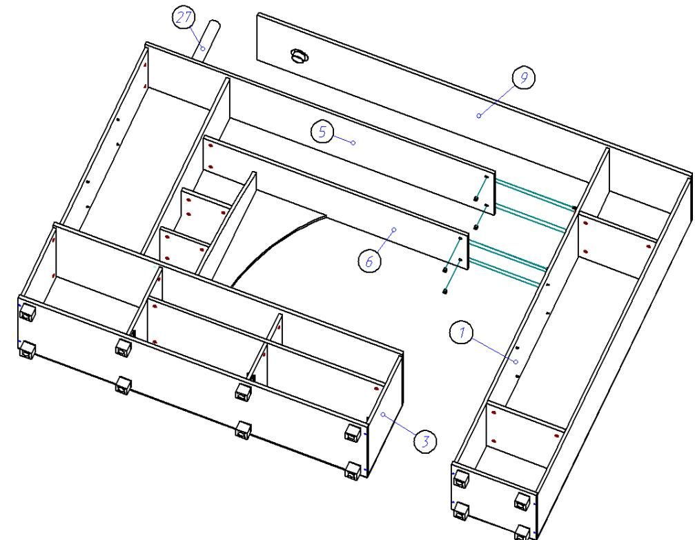
12. При помощи шкантов и стяжек эксцентриковых к бокам (2) крепим крышку (5).
