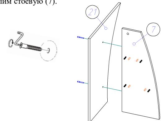
10. При помощи шкантов и стяжек эксцентриковых к стоевой (7) и панели (21) крепим горизонт (6).
