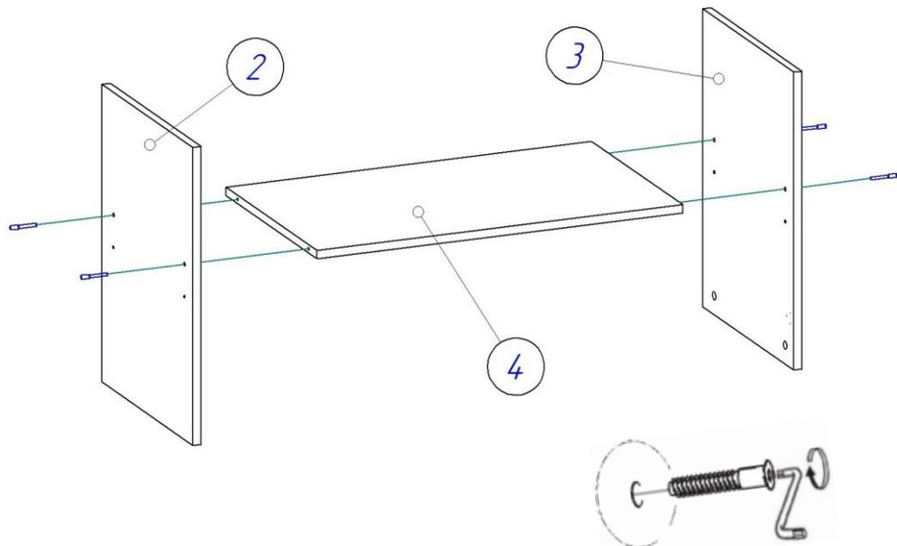
3. При помощи стяжек эксцентриковых и шкантов 8\*30 крепим дно (1) к собранной в предыдущем пункте конструкции. В отверстия на боках (5,6) и стоевых (2,3) устанавливаем полкодержатели, на которые в дальнейшем будут устанавливаться полки (7).
