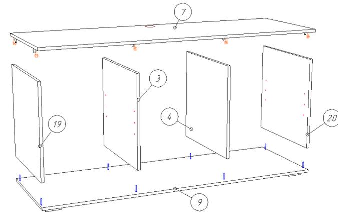
4. При помощи евровинтов 6,3\*50, шкантов 8\*30 и стяжек эксцентриковых собираем конструкцию по схеме.
