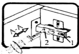
Если фасад наклонен вправо или влево относительно вертикали корпуса, нужно выправить наклон фасада в направлении А-А винтом 2.
