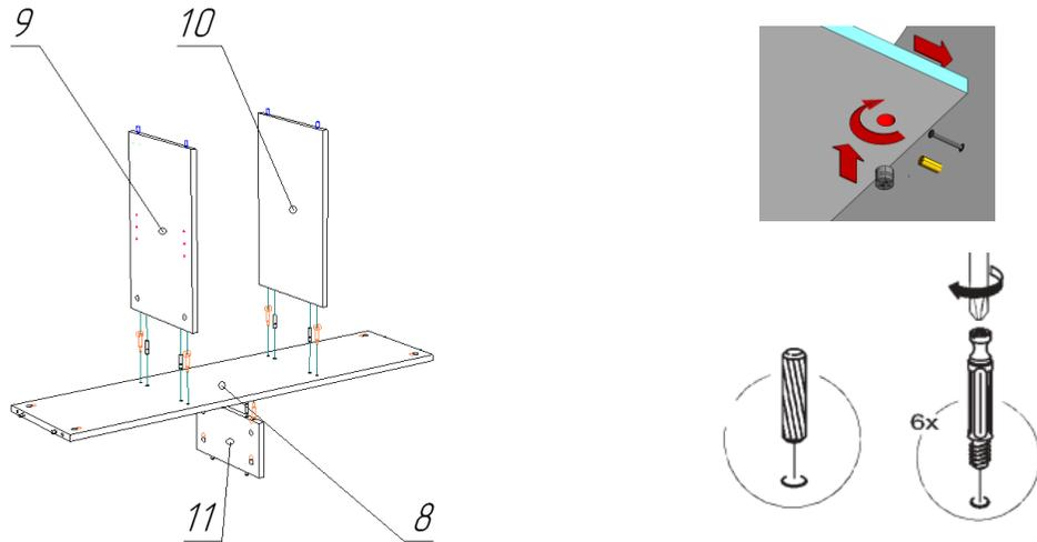
2. При помощи евровинтов 6,3\*50 крепим горизонт (5) к стоевым (9,10), далее к горизонту 8 на эксцентриковые стяжки и шканты ставим стоевые (1,2).
