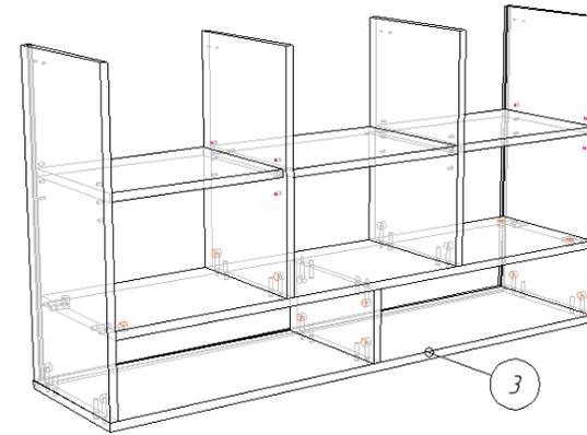
4. Переворачиваем каркас полки лицевой стороной вниз. В пазы устанавливаем задние стенки ДВП (14,15) вставив соединительный профиль для ДВП. и на евровинты 6,3\*50 прикручиваем крышку (4). Далее саморезами 4\*30 к бокам прикручиваем регулируемые подвесы. Для этого в задних стенках прорезаются отверстия для фиксирующего крючка, корпус самого подвеса прижимается вплотную к задней стенке. Далее гвоздями 1,2\*20 прибиваем задние стенки (14,15) к горизонтам и стоевым.
