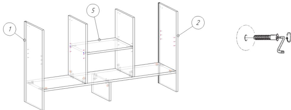
3. На эксцентриковые стяжки и шканты крепим дно (3) на собранный ранее каркас.
